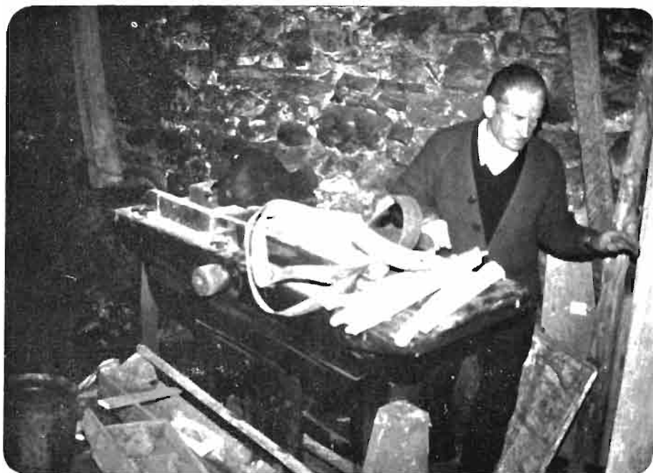
Foto 7.—Cepilladora combinada. Se puede ver la polea que le transmite el movimiento.
