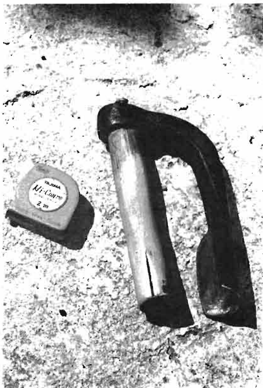
Foto núm 8.—“Zuela” o “Juela” utilizada por los cuchareros para hacer la “boca” a los “chucones” de boj.
