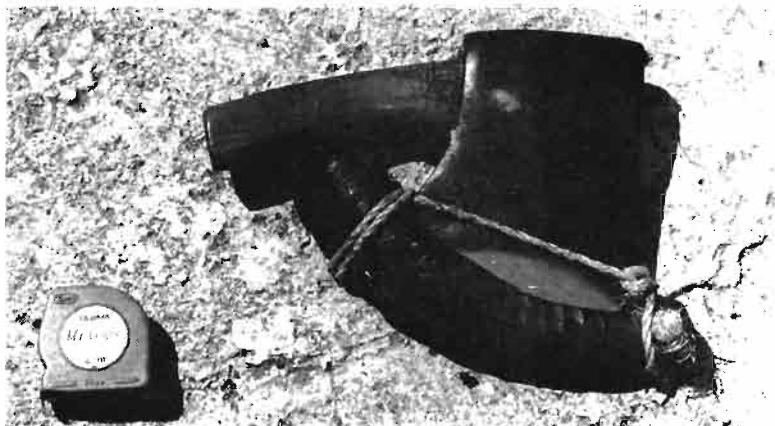
Foto núm. 6.—Hacha de "acuñar" con protección de filo hecha con cuerno de cabra. Herramienta del cucharero Marcos Saragüeta, de Mezquíriz.
