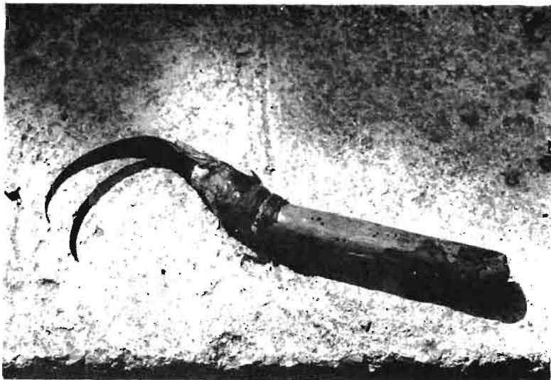
Foto núm. 9.—“Legra”, herramienta de corte curvo que utilizan para refinar el hueco de la cuchara. Muy parecida a esta herramienta es el “Ambruch” o “Ambrus” - Mezquíriz.
