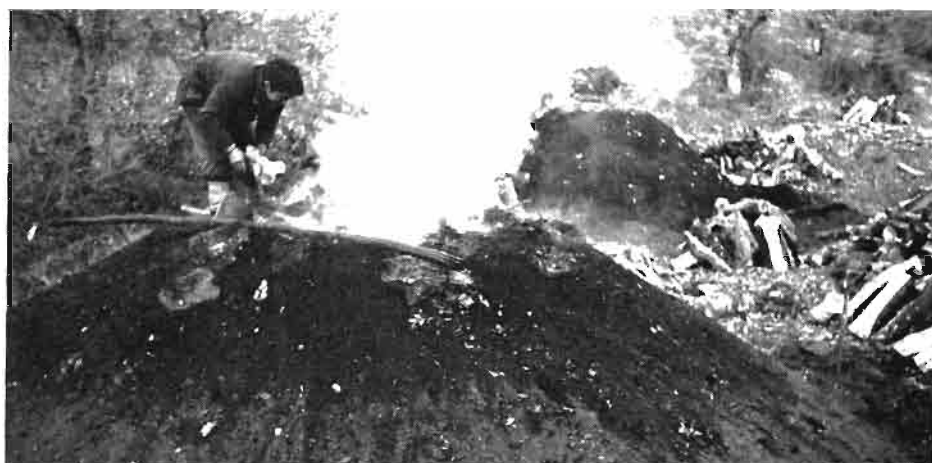
Foto 5.—Introduciendo los “machos” en la carbonera.
