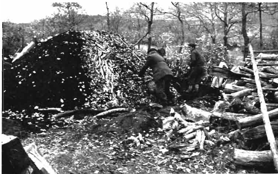
Foto 1.—Terminando de armar la carbonera.
