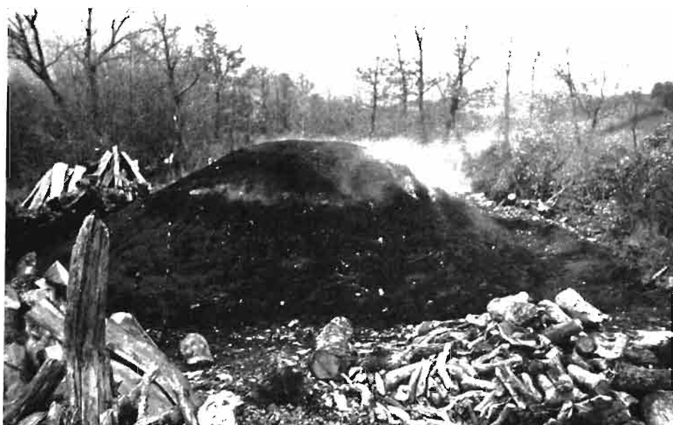
Foto 2.—Agujeros laterales para regular la cocción del carbón.
