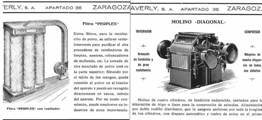
Lámina 3. Maquinaria de una fábrica de harinas. Turbina, filtro y molino
