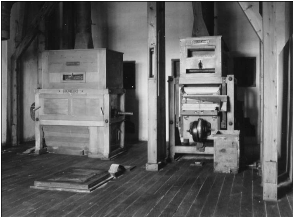
Foto 3. Separador de trigo y despuntadora
