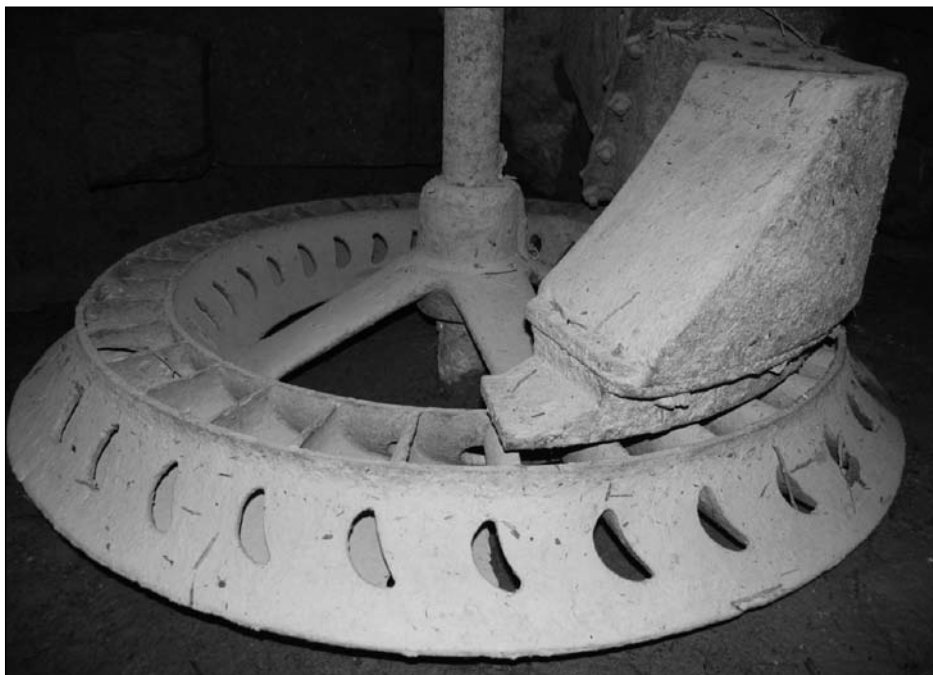
Figura 10. Rueda motriz o rodete del molino de Mérida. Se observan el eje de la rueda, las paletas y el saetín
