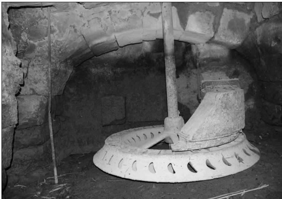
Figura 5. Bóveda o cárcavo, con la rueda motriz. A la izquierda se observa la vara de alivio
